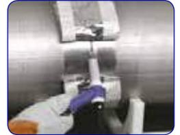
Dopo la saldatura, l'adesivo non viene mai in contatto con il giunto saldato, creando una saldatura pulita e priva di contaminazioni
