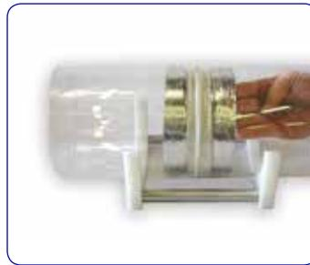
Partendo dal centro e muovendosi lentamente verso l'esterno, applicare il nastro adesivo in alluminio all'area intorno alla fessura, determinando una tenuta salda e priva d'aria.
