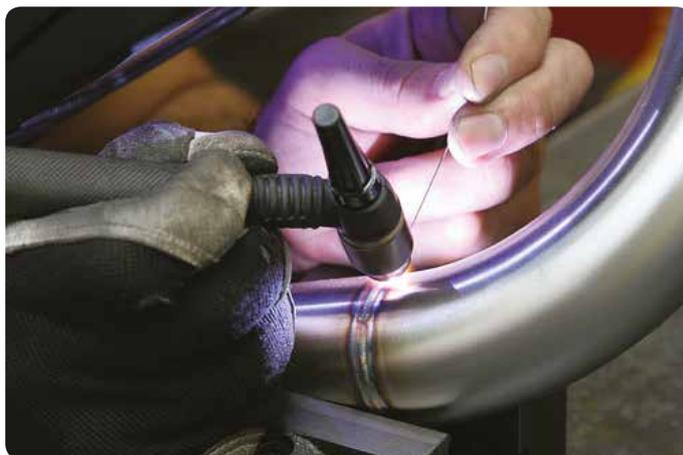
Saldatura TIG a gomito di acciaio inox
