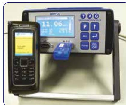
Collegato ad un cellulare tramite Dongle con un range fino a 100 m. Tramite telefono vengono visualizzati tutti i dati rilevanti che comprendono il livello di ossigeno residuo e la temperatura del sensore. Tramite semplici comandi, è possibile utilizzare il PRO PURGE 1 in modalità remota
